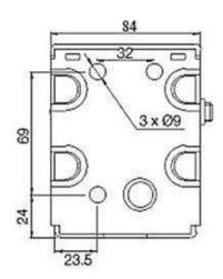
Rozměry základny (vlevo upevnění ze spodní strany, vpravo upevnění pro boční stranu).
